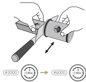
Wende den Rollschleifer und die Schleiflehre wie üblich an. Für ein optimales Ergebnis schleife beide Seiten der Klinge gleich lange.
