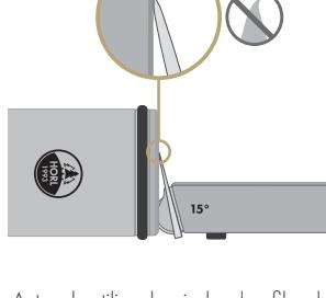
Antes de utilizar la piedra de afilar de corindón fino, asegúrate de que has afilado el cuchillo por ambos lados con el disco abrasivo de diamante HORL®. El filo no debe presentar rebaba.
