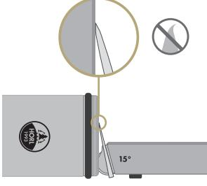
Stelle vor der Anwendung der Edelkorund Schleifsteine sicher, dass dein Messer mit dem HORL® Diamant Standard beidseitig eingeschliffen ist. Die Schneide sollte graffrei sein, um übermäßigen Verschleiß der Steine zu verhindern.
