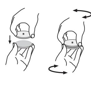
Nettoie soigneusement les surfaces d'aiguiseuse, le support magnétique et le couteau avant et après chaque séance d'aiguisage. Tu peux nettoyer les pierres #3000/#6000 en les frottant légèrement les unes contre les autres dans un mouvement circulaire.
