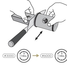
Utilise l'aiguiseur et son support comme à l'habitude. Afin d'obtenir un résultat optimal, aiguisé aussi longtemps les deux côtés de la lame de façon régulière et constante.
