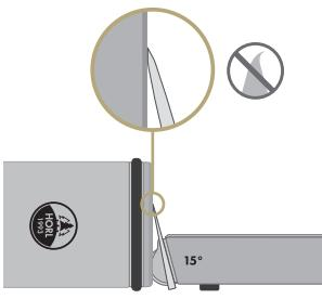
Avant d'utiliser la pierre en corindon, veille à ce que ton couteau est appris parfaitement l'angle d'affûtage avec le HORL diamant standard. La lame doit être sans salissure.
