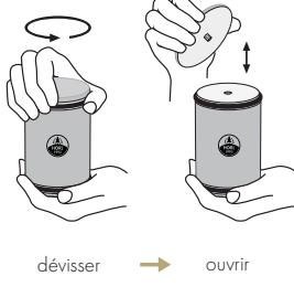
Dévisse la surface d'affûtage de l'aiguiseur et remplace-la par une des pierres #3000/#6000. Visse la surface d'affûtage avec précaution et une force modérée.
