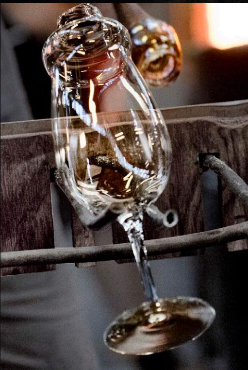
7. Assistenten knackar sedan av glaset från pipan i en gaffelliknande hållare. Därifrån hämtas glaset av en imbarare, som sätter det i ett kylrör för långsam avsvalning. Efter avkyllningen görs en första kvalitetskontroll av en synare. Om glaset håller Orrefors höga kvalitetskrav går det vidare till efterbearbetning.
