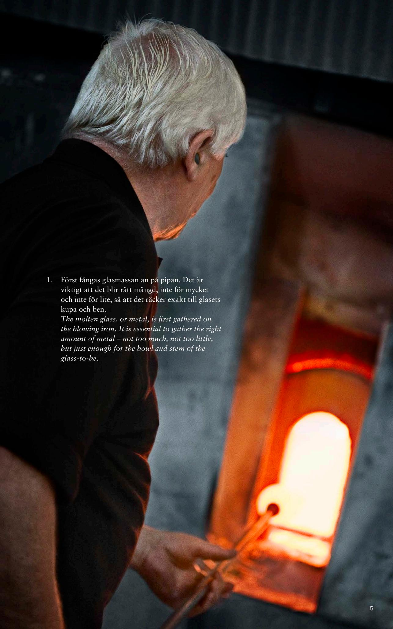
1. Först fångas glasmassan an på pipan. Det är viktigt att det blir rätt mängd, inte för mycket och inte för lite, så att det räcker exakt till glasets kupa och ben.
